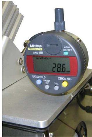
**Digital Readout of Opening Diameter – PN: R287**
